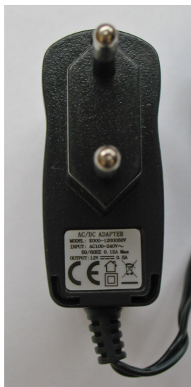
8 – ALIMENTATORE PER ANELLO LED (USCITA: 12VCC 0.5A)
