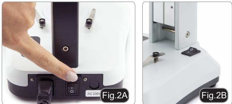
Fuer den SFX Typ drücken Sie die Taste mehrfach, um die Lichtintensität zu ändern. Je nach dem Typ, kann die Lichtintensität -mit Hilfe des Knopfes auf der Rechtseite von dem Stativ - eingestellt werden. (Fig. 3-4)
