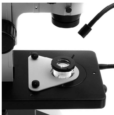
FIG. 6: DIAFRAGMA DE APERTURA PARA CAMPO OSCURO
