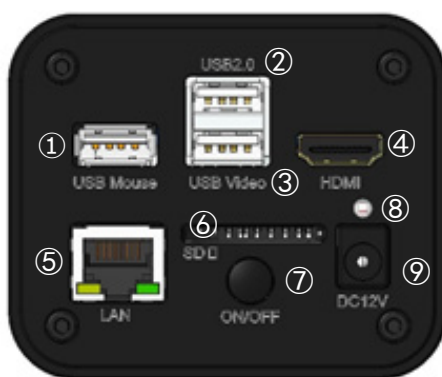
Fig. 1 - Panneau arrière de la C-HUB4K
