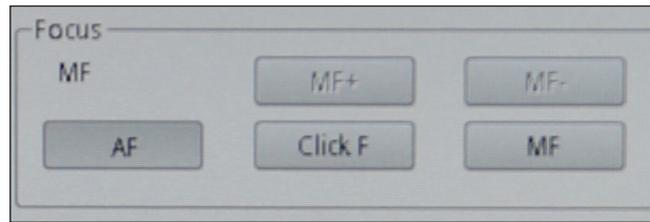
Cliccando su **“MF”** la telecamera lavora in modalità fuoco manuale. L’attivazione del tasto MF attiva automaticamente i tasti **“MF+”** e **“MF-”**, con i quali è possibile agire sulla messa a fuoco della telecamera senza dover agire sul supporto meccanico, semplicemente utilizzando il mouse.
