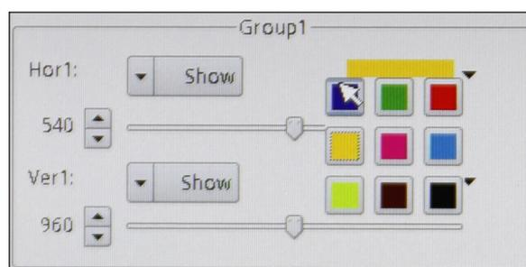
Le righe, una volta tracciate possono essere visibili o nascoste. Cliccando sul tasto “**Show / Hide**” si apre il menù di contesto con il quale è possibile visualizzare una riga “**Show**” o nascondere la “**Hide**”. Le righe, se nascoste, non verranno eliminate dalla memoria ma semplicemente non saranno visibili.
