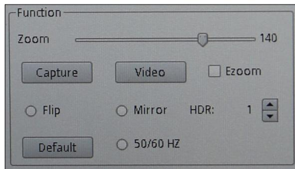
Un settaggio “**HDR**” di 0 indica che la telecamera acquisirà una singola immagine e la archiverà. Aumentando il numero (max 3) la telecamera acquisisce 3 immagini a esposizioni diverse (in genere una sottoesposta, una a esposizione ottimale ed una sovraesposta), le combina per ottimizzare le varie zone ad illuminazione diversa e crea un’immagine singola ad esposizione “virtualmente corretta”.
