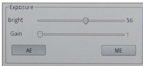
Attivando la funzione **"ME"** la telecamera lavora in modo manuale. E' quindi necessario agire sui parametri della telecamera per adattare il tempo di esposizione alla condizione di illuminazione del campione.
