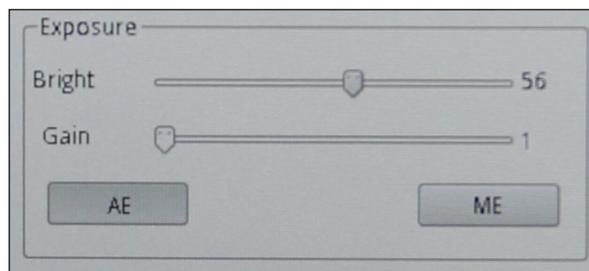
La telecamera può lavorare in esposizione automatica. Attivando la funzione **“AE”** la telecamera lavora in modo totalmente automatico. In questo caso non è possibile agire sui parametri della telecamera, quindi in situazioni di illuminazione non sufficiente è possibile che la telecamera non riesca a fornire una qualità dell’immagine ottimale.
