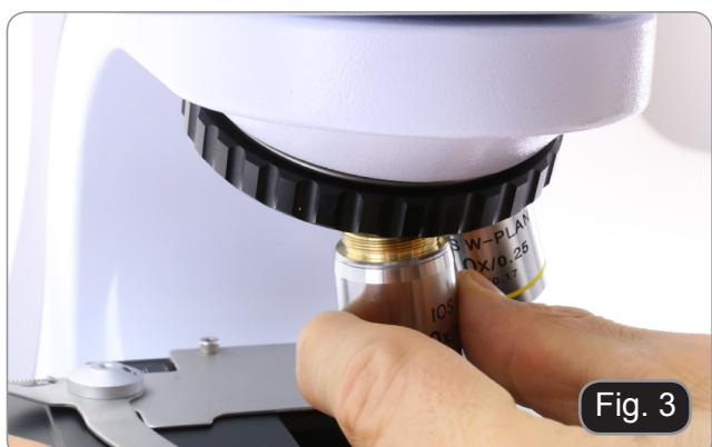
4. Schrauben Sie jedes Objektiv nach Vergrößerung (von der kleinsten bis der grössten Vergrößerung) in den Revolver ein. (Fig. 3)
