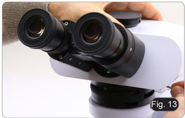
5. Insérer les oculaires dans les tubes porte oculaires de la tête optique. (Fig. 14)
