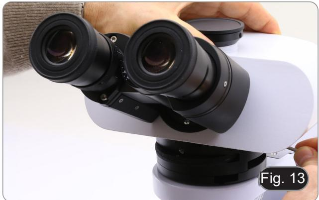
5. Führen Sie beide Okulare in die Röhrenöffnungen ein. (Fig. 14)
