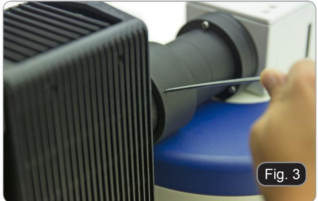
4. Insérez la tête optique au-dessus de l'appareil et serrez la vis à l'aide de la clé Allen de 2 mm fournie. (Fig. 4)
