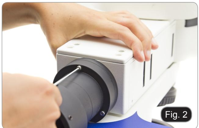
3. Visser le boîtier de la lampe sur le tube de rallonge en serrant les vis à l'intérieur des trous. (Fig. 3)
